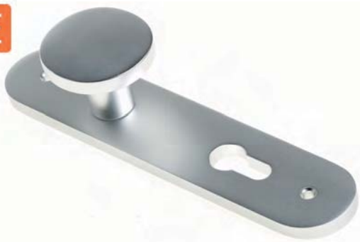
Aluminium knop - krukpaar D - model Vastdraaibare en geveerde kruk op schild met PC-sparing Inclusief 8 mm krukstift en bevestigingsschroeven voor deurdikte 37 - 56 mm
