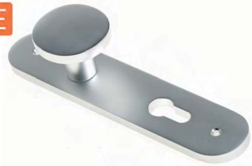
Aluminium knop - krukpaar L- model Vastdraaibare en geveerde kruk op schild met PC-sparing Inclusief 8 mm krukstift en bevestigingsschroeven voor deurdikte 37 - 56 mm
